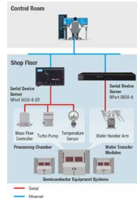
Een producent van halfgeleidersystemen gebruikt de NPort seriële device servers voor de koppeling van kritische componenten in verwerkings- en transferinstallaties.
